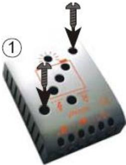
컨트롤러는 벽에 또는 적당한 곳에 그림과 같이 나사를 이용하여 고정합니다. 나사는 4mm 굵기와 최대 8mm 볼트 머리지름을 가진 것이 가능합니다. 옆쪽에 통풍구를 막지 말아 주십시오
